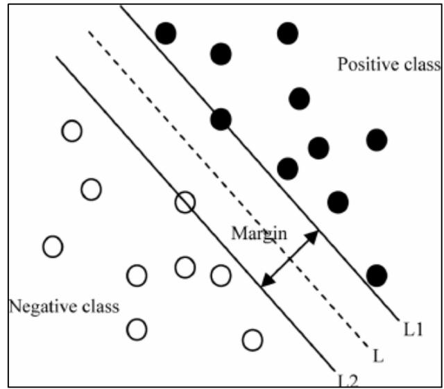
Fig 7.SVM with linear separable data.
